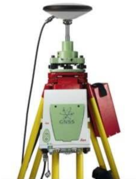
3.7 Сурет – LEICA Viva Gs10 екі жиілікті қабылдағышы
